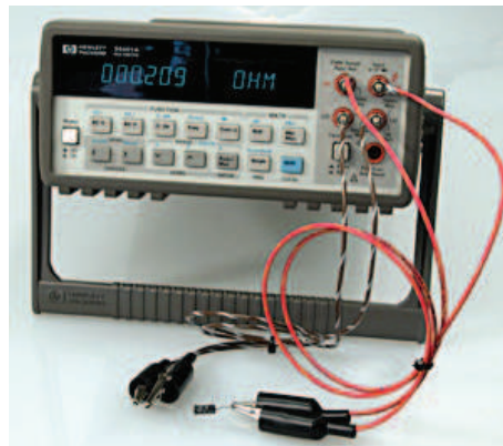
Figur 11.3: Instrument som anvender firledermåling for måling av resistans.
