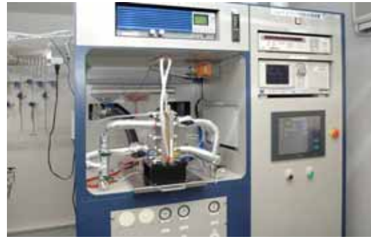
Fig. 3. PEMFC test bench
