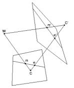
Fig. 2. Fundamental matrix:  $m^T \cdot F \cdot m = 0$ .
