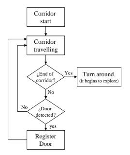
Fig. 5. Flux diagram.
