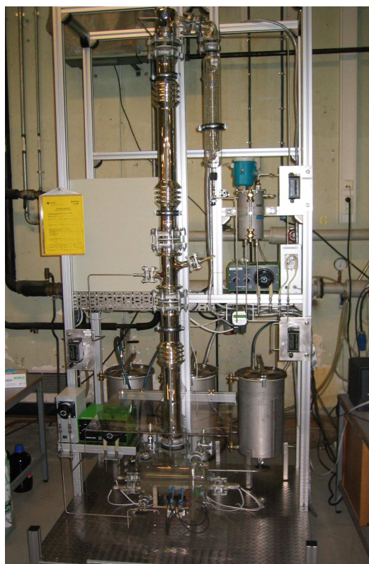
Figur 2.1: Bilde av destillasjonskolonnen.
