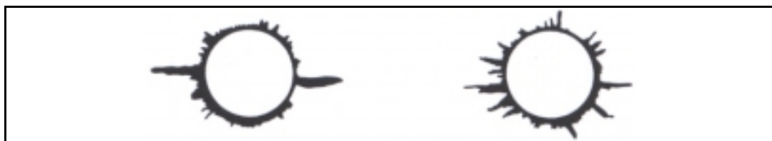
Figur 1.5 Sprekkdannelse rundt to nabohull ved samtidig utløsning av støtbølge i begge hull.
