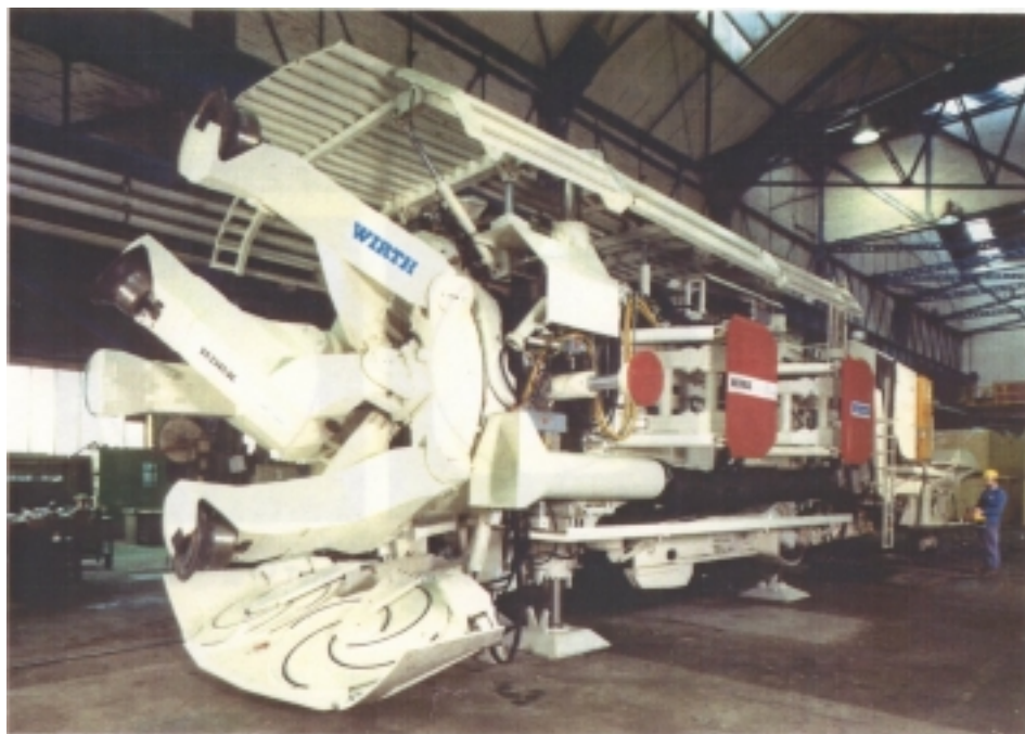
Figur 3.19 Continuous miner med armer fra Wirth Maschinen.
