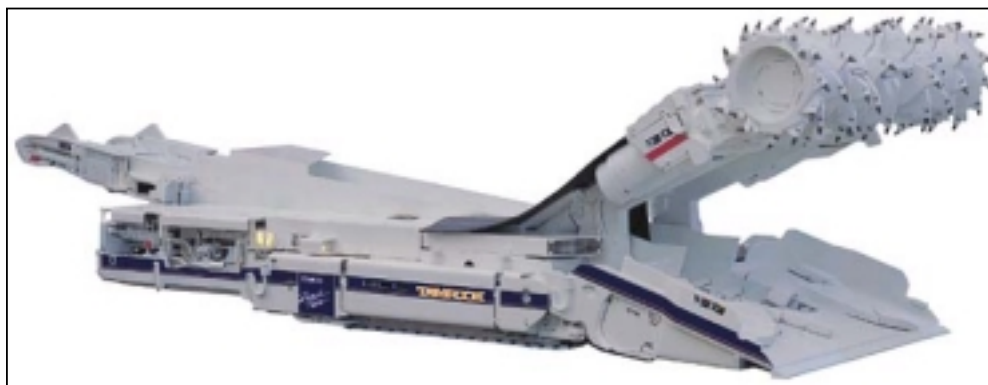
Figur 3.16 Continuous miner med transversalt roterende trommel fra Tamrock.
