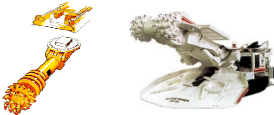
Figur 3.15 Skisse av roadheaderbom med longitudinal rotasjon fra Herrenknecht (t.v.) Roadheader (Alpine Miner) med transversalt roterende trommel fra Sandvik Voest-Alpine Bergtechnik (t.h.).
