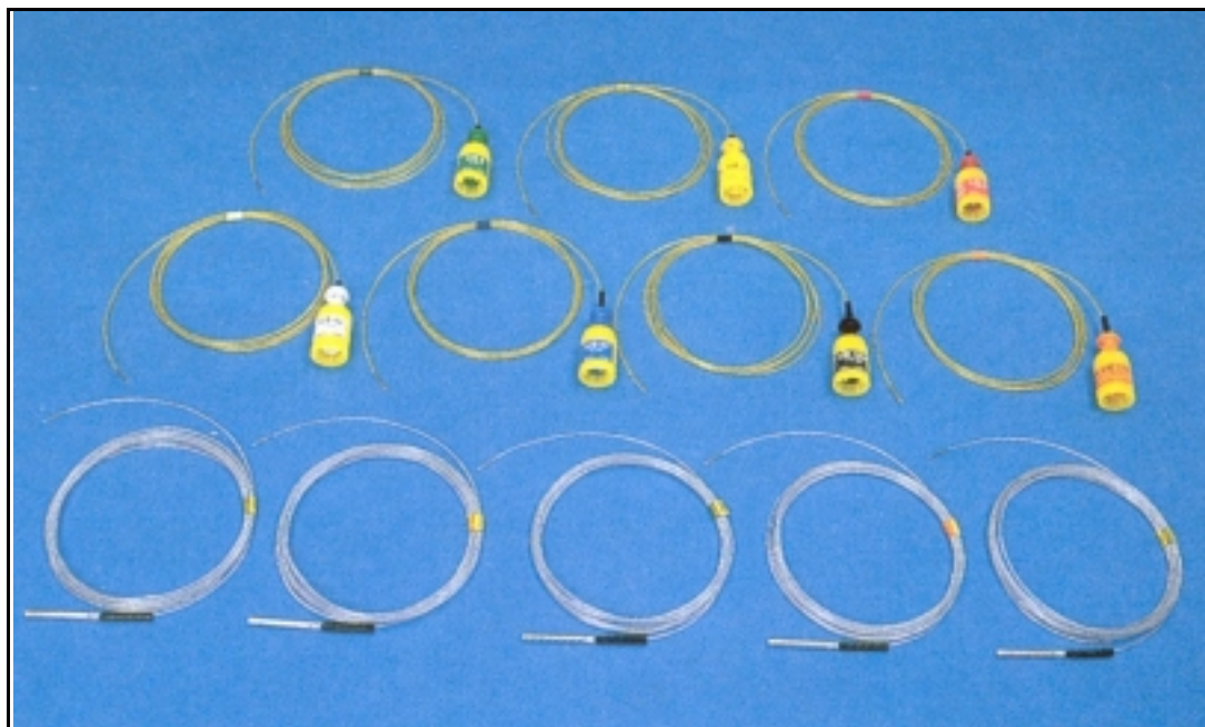
Figur 2.5 Nonel Unidet-systemet. /Dynos produktkatalog/. Øverst er det 7 koblingsblokker med forsinkertid på 0, 17, 25, 42, 67, 109 og 176 millisekund. Nederst er det 5 intervalltenner med forsinkertid på 400, 425, 450, 475 og 500 millisekund. Nonel-slangen ligger i bunter.
