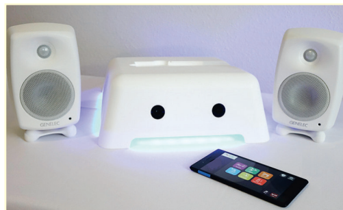
Abb. 1 | Das Gerät verwendet zwei Videokameras (Stereovision-Technologie), um die menschliche Gestalt zu erfassen. Die Auswahl, welcher Körperteil verfolgt wird, welche Geste erforderlich ist und welche Musik gehört wird, erfolgt über einen Tablet-Controller
