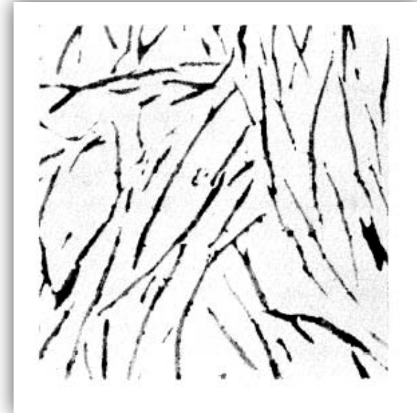
Mikroslip av grått støpejern med grove grafittlameller (mørke tråder). Polert og uetset. 50X.
