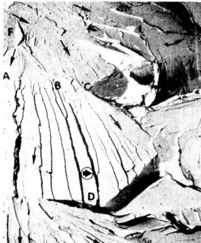
Figur 3.2 Kløvningsbrudd i jern (Transkrystallinsk). Pilene angir brudedretningen i de enkelte korn. Forstørrelse 3200X.
